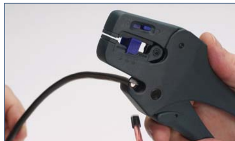
Режет провода сечением до 10 мм 2 /8 AWG
