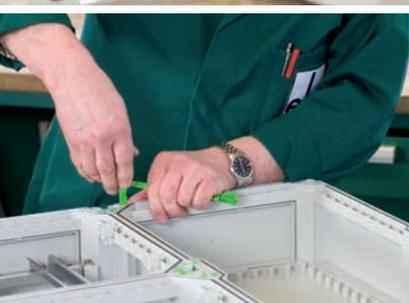
**2.) Gehäuse mittels Verbinder zusammenstecken**
