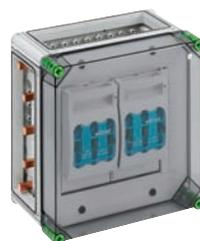
NH 00-Reiter-Lasttrennergehäuse (125 A) - Industrie Qualität - Reiterlasttrenner, 70 mm<sup>2</sup>, Abgang universal, PE-Abgangsklemme 35 mm<sup>2</sup>, N-Abgangsklemmen 35 mm<sup>2</sup>, 3 x Gehäuseverbinder (GGV)
