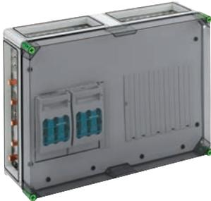
NH-Reiter-Sicherungs-Lasttrennschaltergehäuse mit zusätzlichem Anschlussraum, - Industrie Qualität -, 2 x NH 00 Reiter-Sicherungs-Lasttrennschalter mit Schellenanschluss 70 mm<sup>2</sup>, Bemessungsstrom 125 A, Abgang oben, auf Sa-Schiene, 5-polig, mit transparentem Deckel, mit 5 Sammelschienenklemmen 16 - 70 mm<sup>2</sup>, mit je 2 PE- und N-Abgangsklemmen 1,5 - 35 mm<sup>2</sup>, 3 x Gehäuseverbinder (GGV)
