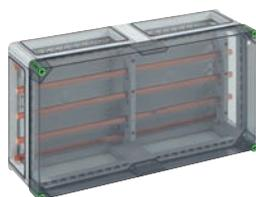
Sammelschienenengehäuse, 5-polig 250A, 250 A, - Industrie Qualität - , mit Cu-Schienen L1...L3 12x10mm, PE, N 12x5mm, ohne Klemmen, zur individuellen Bestückung, mit transparentem Deckel, 4x Gehäuseverbinder (GGV)
