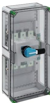
Lasttrennschaltergehäuse - Industrie Qualität - mit externer Betätigung, abschließbar, 1 x 630 A Lasttrennschalter, 3-polig schaltend, M12, PE/N-Klemme (M12), 3 x Gehäuseverbinder (GGV)
