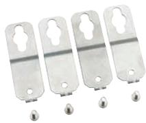
Außenbefestigungslasche zur Montage einzelner Gehäuse oder kleiner Anlagen an ebenen Wandflächen, kann am Unterkasten im Winkel 0°, 45° oder 90° befestigt werden, Wandabstand 10 mm
