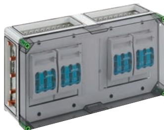
NH 00-Reiter-Lasttrennergehäuse (125 A) - Industrie Qualität - Reiterlasttrenner, 70 mm<sup>2</sup>, Abgang universal, PE-Abgangsklemme 35 mm<sup>2</sup>, N-Abgangsklemmen 35 mm<sup>2</sup>, 4 x Gehäuseverbinder (GGV)
