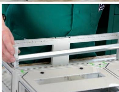
**3.) Sammelschienen, Montageplatten oder weitere Einbauten montieren**
