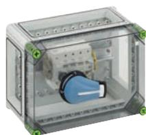
Lasttrennschaltergehäuse - Industrie Qualität - mit externer Betätigung, abschließbar, 1 x 80 A Lasttrennschalter, 3-polig schaltend, Käfigklemme 4-50 mm<sup>2</sup>, PE/N-Klemme 35 mm<sup>2</sup>, 3 x Gehäuseverbinder (GGV)
