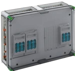
NH-Reiter-Sicherungs- Lasttrennschaltergehäuse mit zusätzlichem Anschlussraum, - Industrie Qualität -, 3 x NH 00 Reiter-Sicherungs-Lasttrennschalter mit Schellenanschluss 70 mm<sup>2</sup>, Bemessungsstrom 125 A, Abgang oben, auf Sa-Schiene, 5-polig, mit transparentem Deckel, mit 5 Sammelschienenklemmen 16 - 70 mm<sup>2</sup>, mit je 3 PE- und N- Abgangsklemmen 1,5 - 35 mm<sup>2</sup>, 3 x Gehäuseverbinder (GGV)
