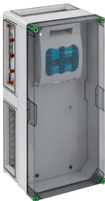
NH 01-Reiter-Lasttrennergehäuse (250 A) - Industrie Qualität - Reiterlasttrenner, M10, Abgang unten, PE-Abgangsklemme 120 mm<sup>2</sup>, N-Abgangsklemmen 120 mm<sup>2</sup>, 4 x Gehäuseverbinder (GGV)
