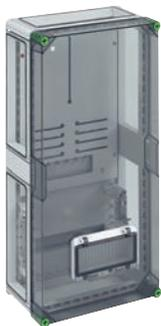
Zählergehäuse - Industrie Qualität -  $U_i=400$ , serienmäßig plombierbar, mit 35 mm Normschiene zum Einbau eines selektiven Hauptschalters, mit montiertem Zählerkreuz für Drehstromzähler und Zählerbefestigungsschrauben, inkl. 2 einpoligen HA-Klemmen 25/16 mm<sup>2</sup> für N und PE
