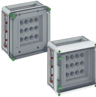
DIAZED-Reiter-Sicherungsgehäuse (25 A), 4 x 3-polige D II-Reitersicherungssockel (25 mm<sup>2</sup>), E 27-Gewinde, AC 500 V, auf Sa-Schiene 5-pol. 250 A, mit Sammelschienenklemmen 35 mm<sup>2</sup> und PE-Abgangsklemme 35 mm<sup>2</sup>, N-Abgangsklemmen 16 mm<sup>2</sup>, 3 x Gehäuseverbinder (GGV)
