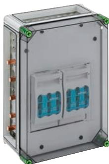
Lasttrennschaltergehäuse mit zusätzlichem Anschlussraum, - Industrie Qualität -, 2 x NH 00 Reiter-Sicherungs-Lasttrennschalter mit Schellenanschluss 70 mm<sup>2</sup>, Bemessungsstrom 125 A, Abgang oben, auf Sa-Schiene, 5-polig 250 A, mit transparentem Deckel, mit je 2 PE- und N- Abgangsklemmen 1,5 - 35 mm<sup>2</sup>, 3 x Gehäuseverbinder (GGV)
