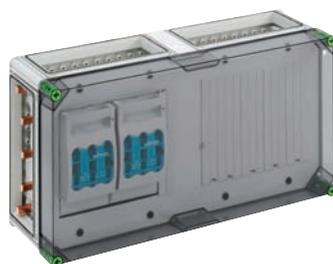
NH 00-Reiter-Lasttrennergehäuse (125 A) - Industrie Qualität - Reiterlasttrenner, 70 mm<sup>2</sup>, Abgang universal, mit Sammelschienenklemmen 70 mm<sup>2</sup> und PE-Abgangsklemme 35 mm<sup>2</sup>, N-Abgangsklemmen 35 mm<sup>2</sup>, 4 x Gehäuseverbinder (GGV)
