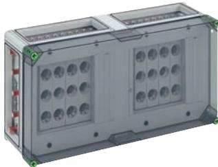
DIAZED-Reitersicherungsgehäuse (25A), 8x3-polige DII-Reitersicherungssockel (25mm<sup>2</sup>), E 27-Gewinde, AC 500V, auf Sa-Schiene 5-pol. 250A, mit Sammelschienenklemmen 35mm<sup>2</sup> und PE-Abgangsklemmen 16mm<sup>2</sup>, N-Abgangsklemmen 16mm<sup>2</sup>, 4x Gehäuseverbinder (GGV)
