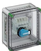
Lasttrennschaltergehäuse - Industrie Qualität - mit externer Betätigung, abschließbar, 1 x 160 A Lasttrennschalter, 3-polig schaltend, M8, PE/N-Klemme (2 x 50 mm<sup>2</sup>, Schellenanschluss), montiert auf Montageplatte, 3 x Gehäuseverbinder (GGV)
