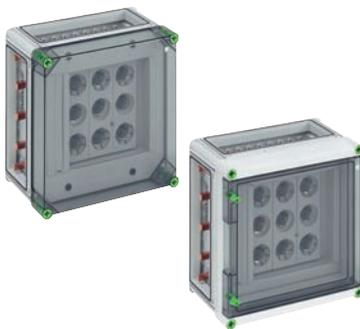
DIAZED-Reiter-Sicherungsgehäuse (63 A), 3 x 3-polige D III-Reitersicherungssockel (35 mm<sup>2</sup>), E 33-Gewinde, AC 690 V, auf Sa-Schiene 5-pol. 250 A, mit Sammelschienenklemmen 35 mm<sup>2</sup> und PE-Abgangsklemme 35 mm<sup>2</sup>, N-Abgangsklemmen 16 mm<sup>2</sup>, 3 x Gehäuseverbinder (GGV)
