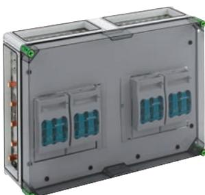
NH-Reiter-Sicherungs- Lasttrennschaltergehäuse mit zusätzlichem Anschlussraum, - Industrie Qualität -, 4 x NH 00 Reiter-Sicherungs-Lasttrennschalter mit Schellenanschluss 70 mm<sup>2</sup>, Bemessungsstrom 125 A, Abgang oben, auf Sa-Schiene, 5-polig, mit transparentem Deckel, mit 5 Sammelschienenklemmen 16 - 70 mm<sup>2</sup>, mit je 4 PE- und N- Abgangsklemmen 1,5 - 35 mm<sup>2</sup>, 3 x Gehäuseverbinder (GGV)
