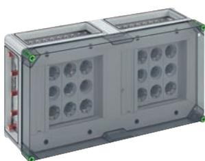
DIAZED-Reiter-Sicherungsgehäuse (63 A), 6 x 3-polige D III-Reitersicherungssockel (35 mm<sup>2</sup>), E 33-Gewinde, AC 690 V, auf Sa-Schiene 5-pol. 250 A, mit Sammelschienenklemmen 35 mm<sup>2</sup> und PE-Abgangsklemme 35 mm<sup>2</sup>, N-Abgangsklemmen 16 mm<sup>2</sup>, 4 x Gehäuseverbinder, 4 x Gehäuseverbinder (GGV)
