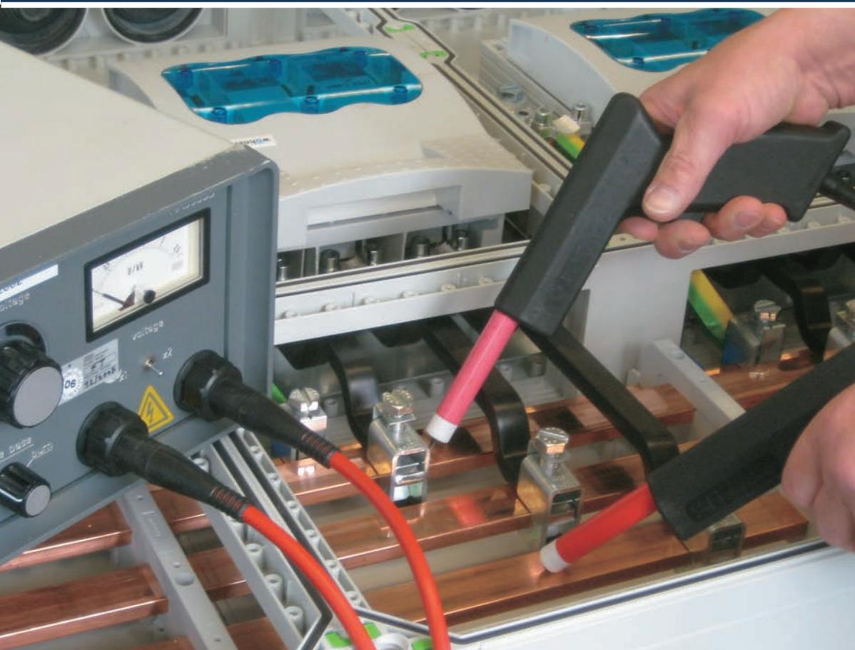
Als weitere Prüfung der Schaltanlage in der Werkstatt muss eine Isolationsprüfung durchgeführt werden. Mit der Isolationsprüfung wird die Isolation zwischen den aktiven Leitern und Körpern sowie die Isolation zwischen den Phasen überprüft.
