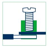
CONTA-CLIP предлагает инновационную программу двухуровневых рядных клемм с проверенным винтовым соединением проводников сечением от 0,5 мм² до 10 мм² в исполнении:
