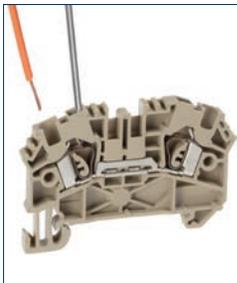
Монтаж и демонтаж проводников всех типов с и без наконечников осуществляется с помощью инструмента, например, отвертки, вставляемой в специальное отверстие. Отвертка, сжимая пружину, открывает контакт. После ввода проводника (до упора), отвертка удаляется. При этом пружина, стремясь занять первоначальное состояние, надежно прижимает проводник к токовой шинке.
