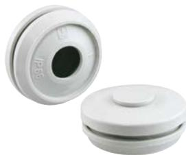
Doppelmembranstopfen, IP66, mit zwei Dichtungsmembranen, geschlossen, thermoplastisches Elastomer (TPE), für Wandstärken 1,5 - 4,5 mm, grau
