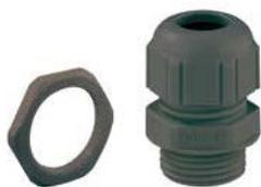
Kabelverschraubung, IP68/IP69\*, mit Zugentlastung, Polyamid, M\_ x 1,5 mm, mit Gegenmutter, schwarz (\* IP69 in Verbindung mit Leergehäusen und Schaltschränken der GEOS-Serie und Verbindungsdosen der Abox Pro-Serie)
