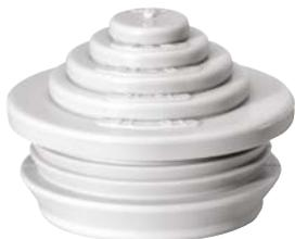
Stufennippel, IP55, mit geschlossener Dichtungsmembran, abschneidbar in mehreren Stufen, thermoplastisches Elastomer (TPE), für Wandstärken von 1,5 - 4 mm, grau
