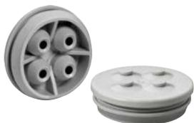
Doppelmembranstutzen, IP66, mit zwei Dichtungsmembranen, geschlossen, max. vier Leitungseinführungen für Steuerleitungen, thermoplastisches Elastomer (TPE), für Wandstärken 1,5 - 4,5 mm, grau
