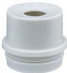
Anbaustutzen IP55, mit offener Dichtungsmembran, thermoplastisches Elastomer (TPE), für Wandstärken von 1,5 - 4,0 mm, grau
