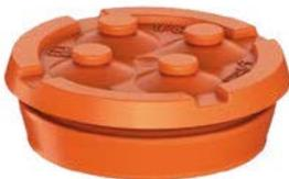
Doppelmembranstutzen, IP66, mit zwei Dichtungsmembranen, geschlossen, max. vier Leitungseinführungen für Steuerleitungen, thermoplastisches Elastomer (TPE), für Wandstärken 1,5 - 4,5 mm, orange
