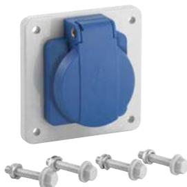
Anbausteckdose 16A, 230V zur seitlichen Montage an Gehäusen AK/AK-F 14/28/42/56/70 sowie Plus-Typen
