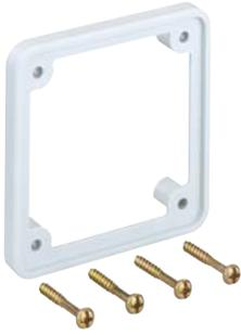
Einbausatz für CEE-Geräte 16A (gerade Ausführung) mit Flanschmaß 75 x 75 mm, Abstand der Befestigungslöcher 60 mm, passend für Einzeldosen
