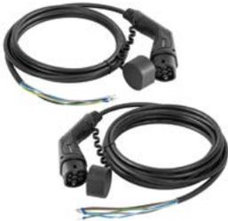
Ladekabel – AC-Ladekabel mit Kupplung Typ 2 gemäß IEC 62196-2 und offenem Leitungsende, mit Schutzkappe, Leitungsaufbau 5 x 2,5 mm<sup>2</sup> + 1 x 0,5 mm<sup>2</sup>, IP54 (mit Schutzkappe), Ladeleistung bis maximal 11 kW (3-phasig), Ladestrom bis maximal 16 A, zur Installation an einer Spelsberg Wallbox
