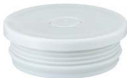
Verschlussstopfen, IP55, mit geschlossener Dichtungsmembran, thermoplastisches Elastomer (TPE), für Wandstärken 1,5 - 4,0 mm, Zum Verschliessen von nicht benötigten metrischen Gehäuseöffnungen, grau
