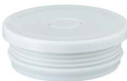
Verschlussstopfen, IP55, mit geschlossener Dichtungsmembran, thermoplastisches Elastomer (TPE), für Wandstärken 1,5 - 4,0 mm, Zum Verschliessen von nicht benötigten metrischen Gehäuseöffnungen, grau
