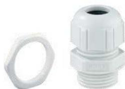
Kabelverschraubung, IP68/IP69\*, mit Zugentlastung, Polyamid, M\_ x 1,5 mm, mit Gegenmutter, grau (\* IP69 in Verbindung mit Leergehäusen und Schaltschränken der GEOS-Serie und Verbindungsdosen der Abox Pro-Serie)
