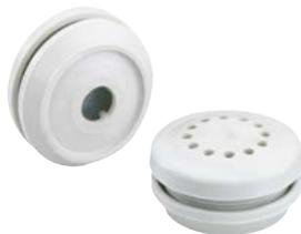
Belüftungsstopfen IP44 mit Labyrinthdichtung zur Vermeidung von Kondenswasserbildung in Gehäusen, Durchfluss 100l/min. bei 0,1 bar Überdruck, thermoplastisches Elastomer, empfohlene Montage an den Gehäuseseiten links und rechts in verschiedenen Höhen (siehe Technischer Anhang - Schutz gegen Kondenswasser), für Wandstärken 1,5 - 4,5 mm
