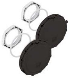
BEL Air Belüftungselemente-Set, zur Vermeidung von Kondenswasserbildung in Gehäusen, zum senkrechten Einbau in Gehäusewände und GFL Kombiflansche mit entsprechender Vorprägung, pro Gehäuse sind mindestens zwei Belüftungselemente erforderlich
