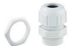
Kabelverschraubung, IP68/IP69\*, mit Zugentlastung, Polyamid, M\_ x 1,5 mm, mit Gegenmutter, grau (\* IP69 in Verbindung mit Leergehäusen und Schaltschränken der GEOS-Serie und Verbindungsboxen der Abox Pro-Serie)
