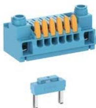
N-Module mit Betätigungshebel zum werkzeuglosen Lösen der Leiter, mit jeweils 2 Schraubklemmen 2,5-16mm<sup>2</sup> und 6 Push-in-Klemmen 0,75-4mm<sup>2</sup> zur Montage auf Basisträgern AK3 3/14 PE oder AK3 6/21 PE
