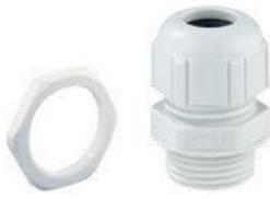
Kabelverschraubung, IP68/IP69\*, mit Zugentlastung, langes Anschlussgewinde, M<sub>x</sub> x 1,5 mm, mit Gegenmutter, Polyamid, grau (\* IP69 in Verbindung mit Leergehäusen und Schaltschränken der GEOS-Serie und Verbindungsdosen der Abox Pro-Serie)
