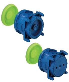
Установочная коробка для приборов, для установки в бетонных стенах с увеличенным монтажным пространством, 4 винта с расстоянием между ними 60 мм, комбинируется с другими подрозетниками, используется для монтажа во встречную опалубку
