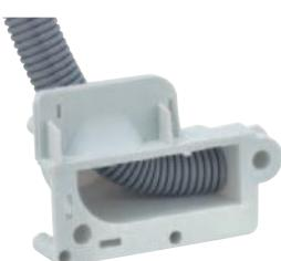
Универсальный переходник для установки в бетонных стенах, применяется для проводки трубы между стеной и потолком или для дальнейшей прокладки труб под монолитным покрытием пола. Вводы для труб до M25. Используется для крепления kleem и для монтажа во встречную опалубку
