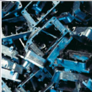
Fertig gegossene Anbauehäuse
