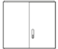
двоє відкидних дверей, ручка-важіль з місцем для замка-напівциліндру - на правих дверцятах
